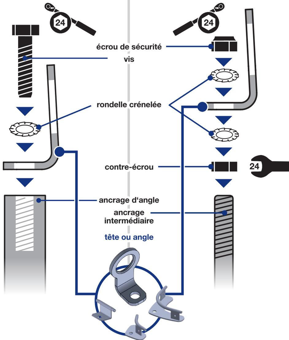
! Pour la protection des filetages, utilisez une pâte de cuivre ou un spray contre la soudure à froid de l'acier inoxydable.
