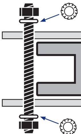
Serrez les quatre vis l'une après l'autre à l'aide d'une clé dynamométrique avec une force minimale de 40 NM.
